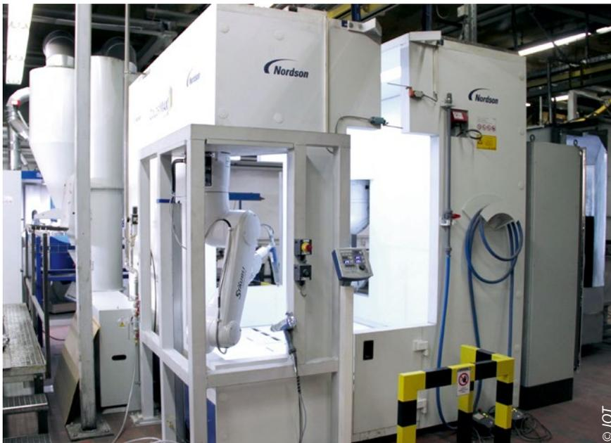
Die Kabine ist individuell auf die Roboterbeschichtung ausgelegt
