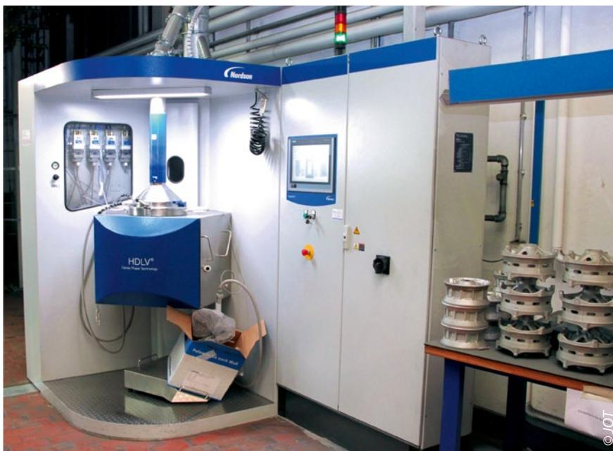
Das Pulverzentrum mit dem prozesskontrollierten Ultraschallsieb, der kompletten Anlagensteuerung und den Dichtstrompumpen
