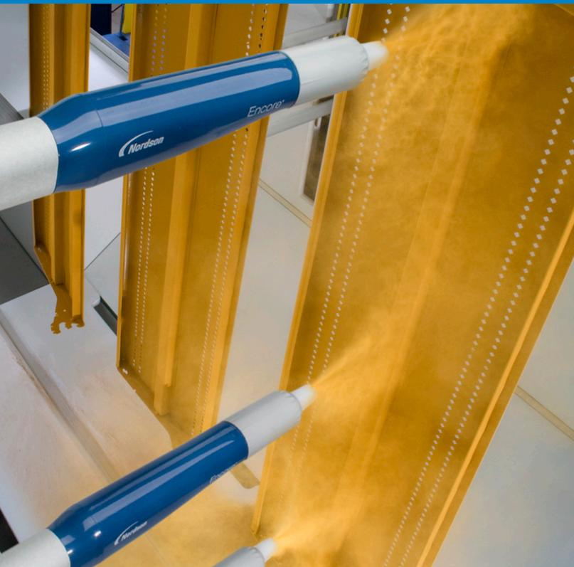
Mit den Encore® Automatik-Sprühpistolen und der Select Charge® Technologie können Beschichter hervorragende Deckung und Effizienz erzielen. Die Sprühpistole kann schnell und problemlos mit Druckluft gereinigt werden, ohne dass hierzu ein Zerlegen erforderlich wird. Dies ist insbesondere für schnelle Farbwechsel in der Pulverbeschichtung unverzichtbar.
