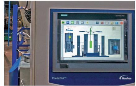
Die Touch-Screen Steuerung mit Pictogrammen erleichtert die Bedienung.
