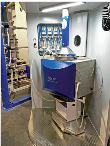
Im Vordergrund die HDLV-Pulverkammer, im Hintergrund hinter Glas sind die Dichtstromförderpumpen zu sehen.
